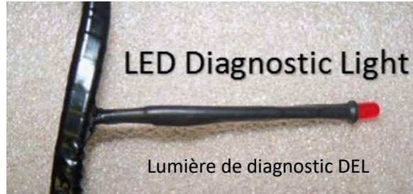
Si une pi ce  lectronique ne fonctionne pas correctement, le syst me cr era un code qui permettra d'identifier le probl me. Chaque code d'erreur s'affiche par une s rie de clignotements avec un voyant d'erreur. En cas de code d'erreur, une lumi re le signalera.
