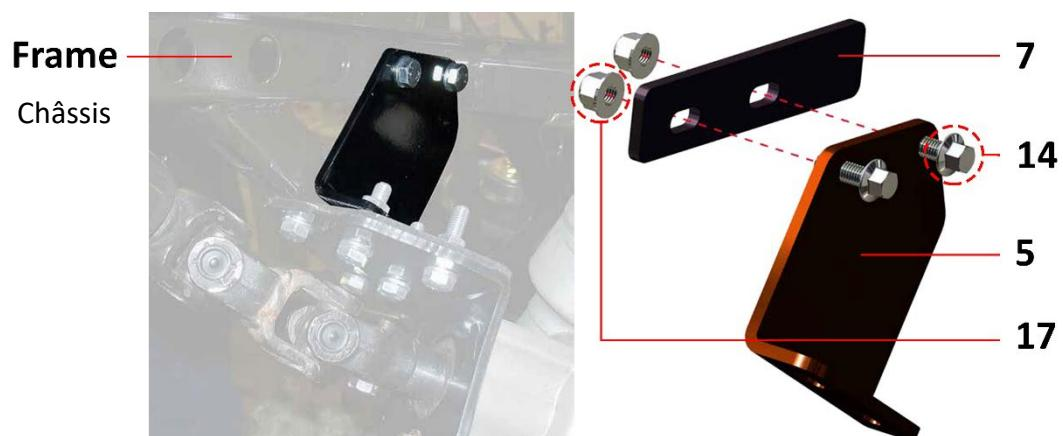
**Étape 4 :** Installer la plaque étroite inférieure (8) à l'intérieur du châssis et la plaque de montage (6) au support de montage (5). Fixer avec les boulons (14) et écrous (17).
