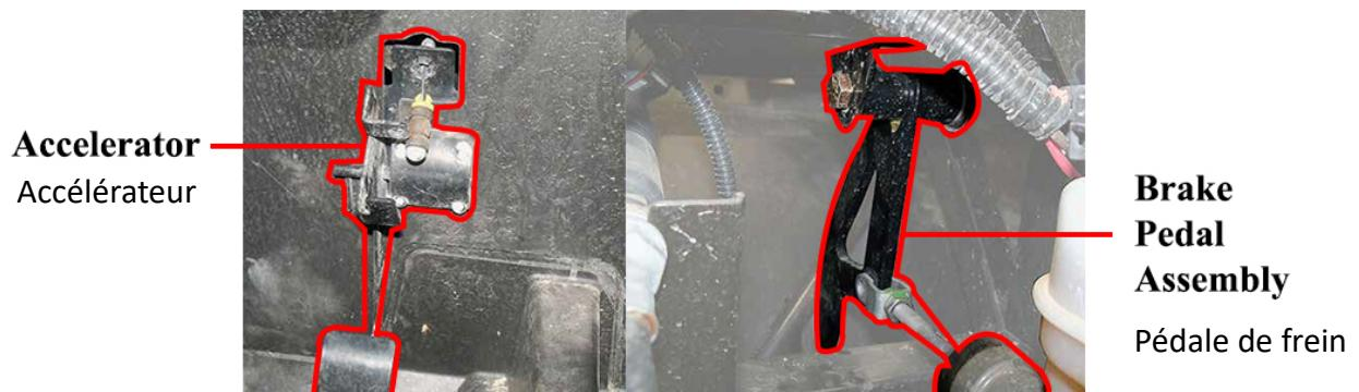
**Étape 9 :** Retirer les rivets en plastique et les vis à tête torx.
