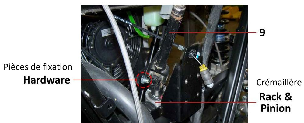
**Étape 2 :** Installer le moteur (1) sur l'arbre inférieur (7) avec les pièces de fixation fournies.
