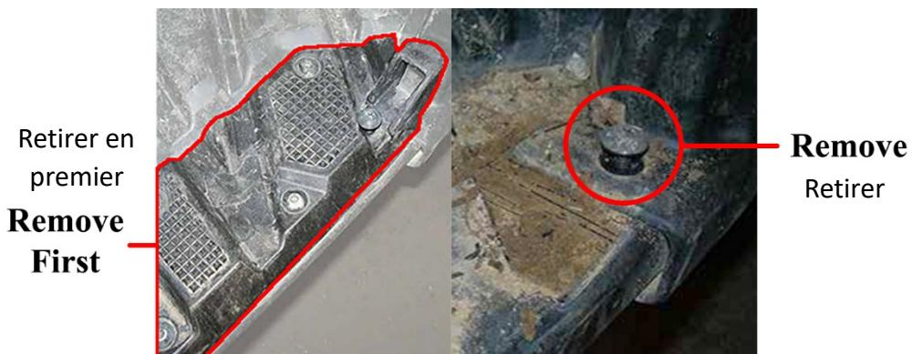
**Étape 11 :** À partir du puits d'aile côté conducteur, retirer le panneau intérieur.
