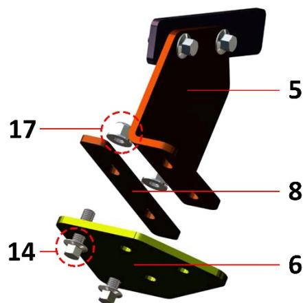
**Étape 5 :** Installer le support de moteur (4) à la plaque de montage (6) avec les boulons (14) et écrous (17). Utiliser deux boulons (14) et écrous (17) pour assembler le support de moteur (4), la plaque de montage (6) et le support de montage (5) ensemble.
